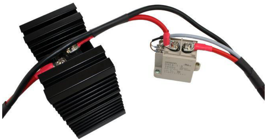
Abb. 3-6 Kühlkörper mit montierter Rückstromdiode und angeschlossenem Lastrelais
