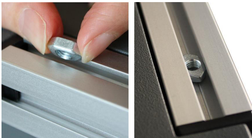
Abb. 10-1 Nutenstein in Profil einlegen
