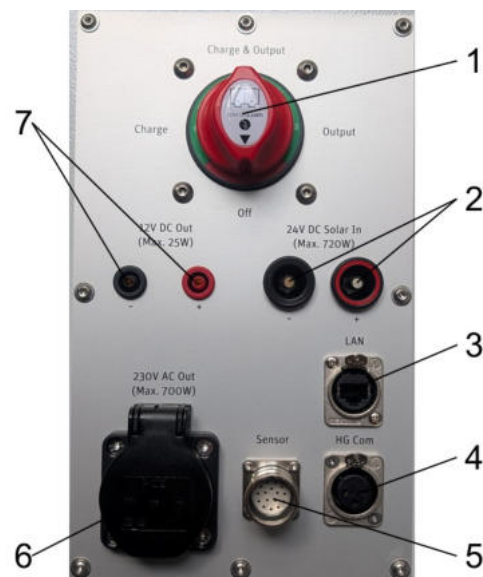
Abbildung 3-3 Benutzerschnittstelle seitlich am Schrank
