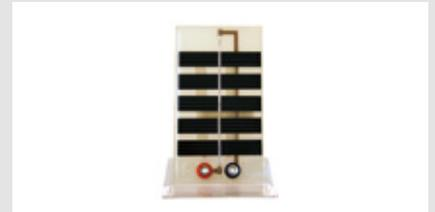
Das 5-zellige Photovoltaikmodul wird für Experimente zur Solarenergie und zur Erzeugung elektrischer Energie für die Wasserstoffherzeugung verwendet. Der praktische Standfuß erleichtert die Ausrichtung zur Lichtquelle. Das Modul lässt sich einfach auf dem Auto-Chassis befestigen, um ein Solarfahrzeug aufzubauen.
