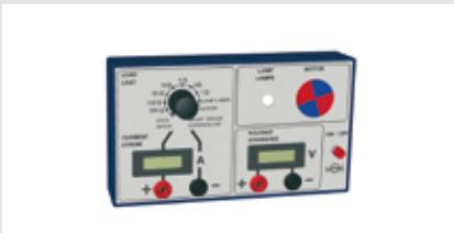
Für fortgeschrittene Experimente dient die Messbox zur Datenerhebung. Integrierte Verbraucher wie Motor, Glühlampe und 7 schaltbare Widerstände ermöglichen eine Vielzahl von Experimenten, wie z. B. die Aufnahme von Kennlinien oder Strom und Spannung.
